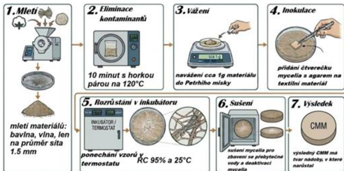
Obrázek 4 Schéma výroby CMM
